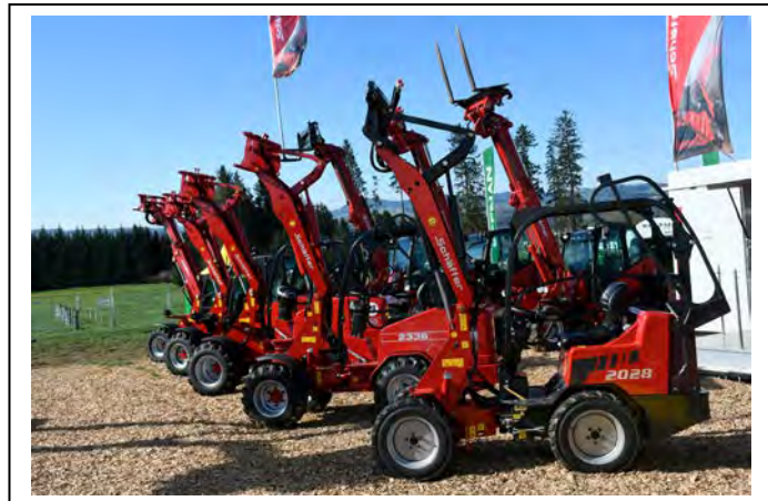
Bild 1: Alle Lader sind mit Kabine(ntür) oder Rückhalteflügeln (nach oben öffnend) ausgerüstet.
